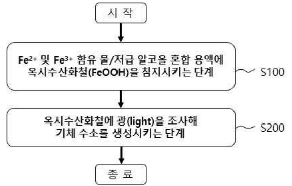
[옥시수산화철을 이용한 수소생산방법 흐름도]
